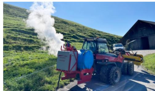
Dampfgerät JAKOB für Dreipunkt am Traktor
